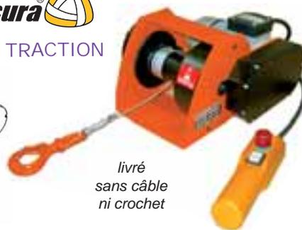
Boîte de commande montée-descente avec arrêt d'urgence / Moteur frein monophasé 230V à condensateur permanent (50Hz type levage). Classe F. Protection IP54 / Puissance moteur adaptée à toute installation, même domestique !
