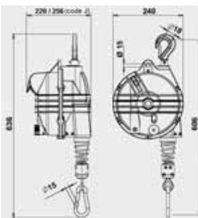
Suspension rotative par crochet de sécurité
