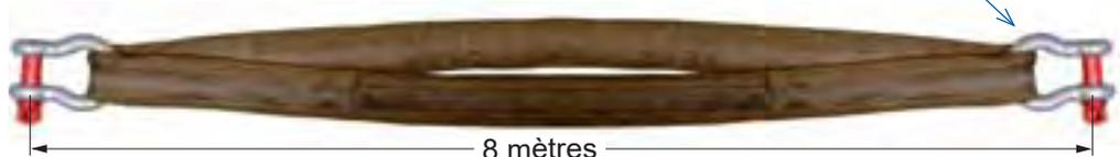
Sangle tissée en polyester traitée anti-abrasion - Très grande résistance aux hydrocarbures - Coefficient de sécurité 7/1 - Boucles renforcées
