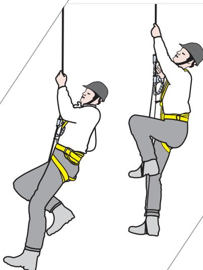
**ACCES SUR CORDE** : Cette technique de progression sur corde ne doit être utilisée que lorsque les méthodes d'accès traditionnelles ne peuvent pas être mises en place. L'équipement de base de l'accès sur corde devra être couplé avec un système antichute
