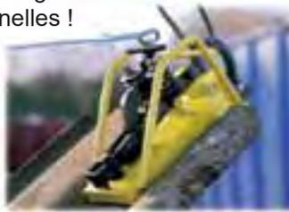
Ces pinces ne sont pas conçues pour l'arrachage des palplanches et ne doivent en aucun cas être utilisées à cette fin.
